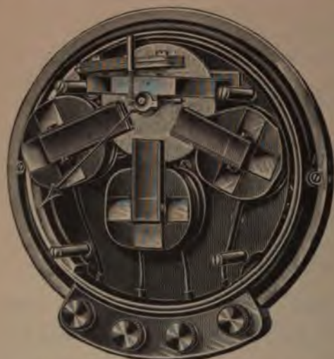
Abb. 456. Induktions-Leistungsmesser der Allgemeinen Elektrizitäts-Gesellschaft.
